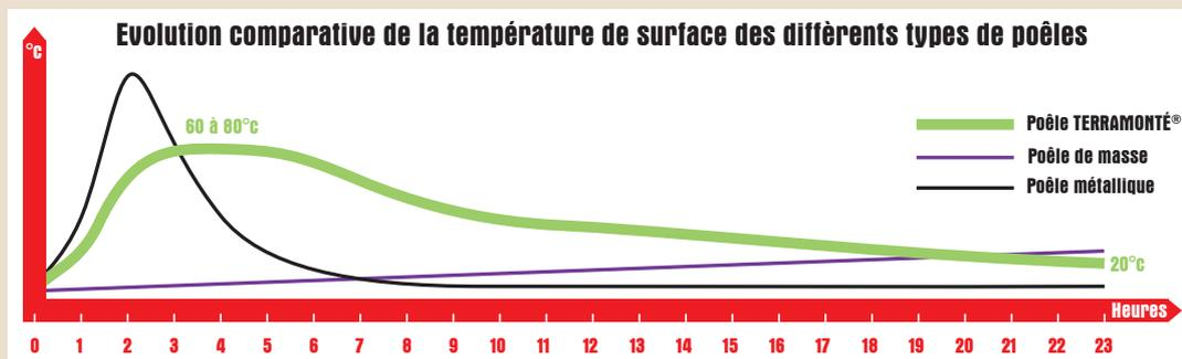
Les poêles TERRAMONTÉ® sont constitués d'un habillage de briques de terre crue (la TERRABRIK®) et de pierre assemblé autour d'un insert métallique. Un circuit de convection ménagé dans l'habillage permet d'atteindre rapidement la température de confort.
