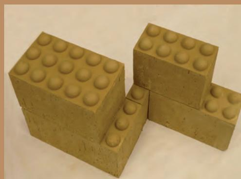
Le remplacement de la cuisson à haute température par le séchage naturel rend leur procédé de fabrication extrêmement économe en énergie. Les étapes d'extrusion sous vide et de compression leur confèrent des caractéristiques thermiques spécifiques, idéales pour l'accumulation de chaleur.
